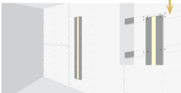
Après avoir fixés les renforts, visser l'élément GypsoComete avec des vis autotaraudeuses à une distance d'environ 3/4 cm du bord. En cas de double plaque, visser le morceau conservé au préalable avant l'application de l'élément GypsoComete.
