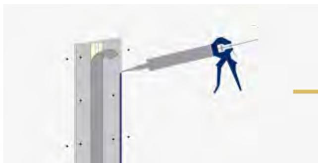
Après avoir vissé l'élément Gypsocomete, exécuter la première phase du traitement du joint en appliquant une couche de mastic colle acrylique. Effectuer le remplissage en prenant soin de rester à 1 mm environ au-dessous du bord de la plaque, afin de favoriser l'application de l'enduit à joint lors de la phase suivante.
