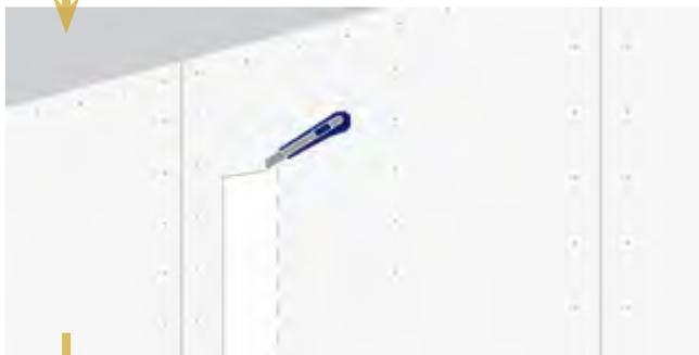
Effectuer la découpe des plaques à l'aide d'un cutter en majorant la largeur du trou d'environ 2/3 mm d'épaisseur par rapport au bord du gabarit. En cas de double plaque, conserver un morceau.
