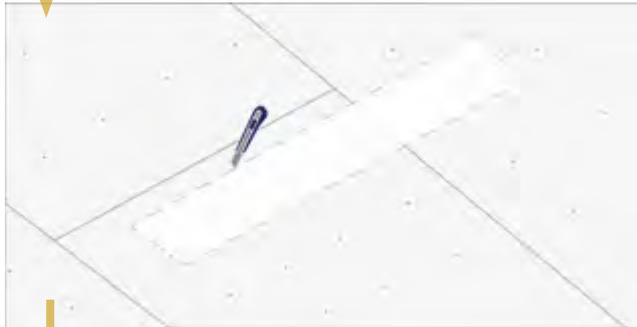
Effectuer la découpe des plaques à l'aide d'un cutter en majorant la largeur du trou d'environ 2/3 mm d'épaisseur par rapport au bord du gabarit. En cas de double plaque, conserver un morceau.
