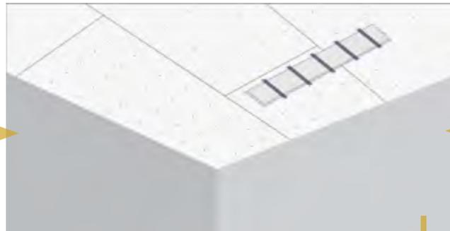
Après avoir retiré les plaques, effectuer le renfort du trou avec des profilés en C 48/15 ou 48/27 positionnés perpendiculairement au trou à un entraxe maximum de 400 mm, en utilisant des vis autotaraudeuses ordinaires à une distance d'environ 3/4 cm du bord. Afin d'obtenir une plus grande rigidité, le premier et le dernier profilé devront être positionnés de telle sorte qu'une moitié soit sous la plaque.
