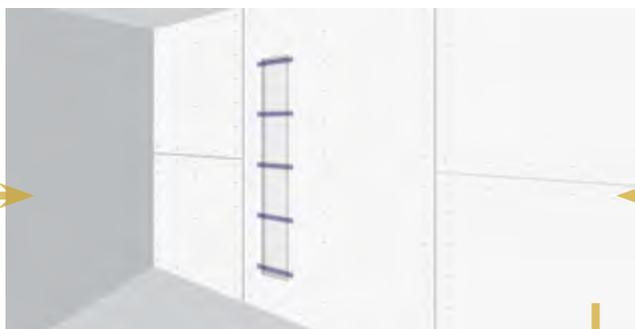
Après avoir retiré les plaques, effectuer le renfort du trou avec des profilés en C 48/15 ou 48/27 positionnés perpendiculairement au trou à un entraxe maximum de 400 mm, en utilisant des vis autotaraudeuses ordinaires à une distance d'environ 3/4 cm du bord. Afin d'obtenir une plus grande rigidité, le premier et le dernier profilé devront être positionnés de tel sorte qu'une moitié soit sous la plaque.
