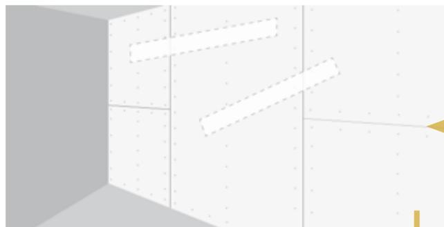
Sur la surface existante du mur, tracer le gabarit de l'élément GypsoComete
