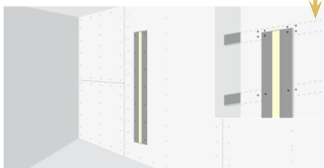
Visser l'élément Gypsocomete avec des vis autotaraudeuses à une distance d'environ 3/4 cm du bord. En cas de double plaque, visser un morceau afin de créer l'épaisseur nécessaire avant l'application de l'élément Gypsocomete.
