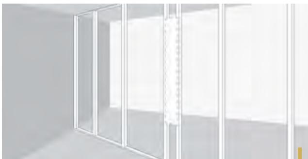
Effectuer l'application ordinaire de la charpente métallique. Après avoir vérifié le point d'installation de l'élément Gypsocomete, prévoir l'introduction de deux montants supplémentaires avec un entraxe de 120 mm.
