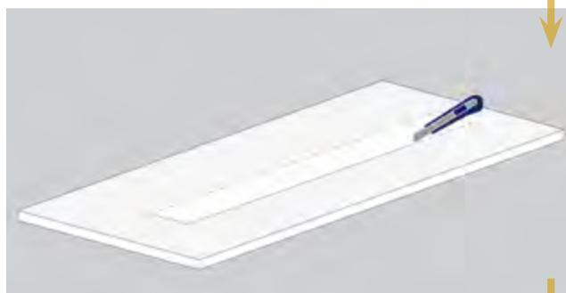
Selon l'installation à une ou deux plaques, tracer le gabarit de l'élément Gypsocomete au sol ou sur la charpente métallique en effectuant la découpe des plaques à l'aide d'un cutter. Majorer la largeur du trou d'environ 2/3 mm d'épaisseur par rapport au bord du gabarit.
