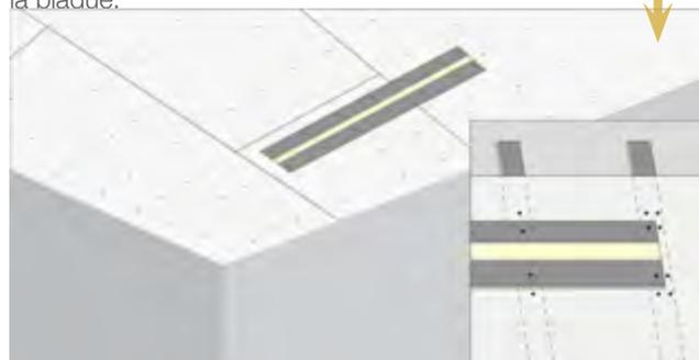
Après avoir fixés les renforts, visser l'élément Gypsocelement avec des vis autotaraudeuses à une distance d'environ 3/4 cm du bord. En cas de double plaque, visser le morceau conservé au préalable avant l'application de l'élément Gypsocelement.
