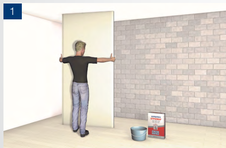
1 Vérification, nettoyage du support et placement de la plaque
