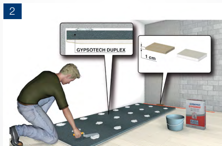
2 Préparation et application des plots du mortier-colle Gypsomaf
