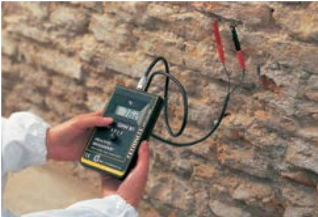
Mesure du niveau d'humidité avec un hygromètre
