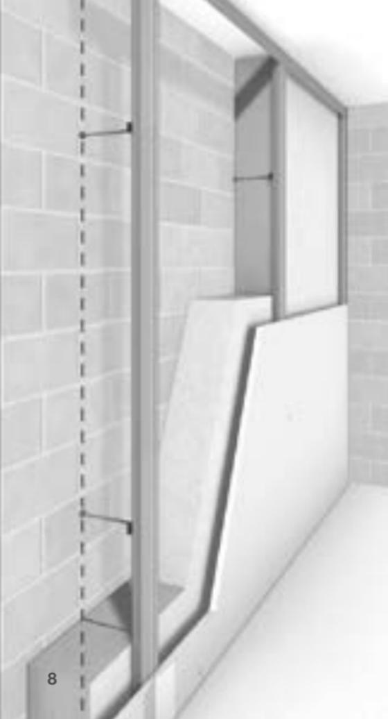
Doublages constitués par vissage d'une épaisseur de plaques de plâtre GYPSOTECH® BA13 ou BA15 d'un seul côté d'une ossature métallique constituée par une file de fourrures GYPSOTECH® F47 avec appuis intermédiaires.
