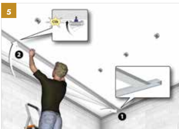
Fixation des montants à crochets d'espacement.
