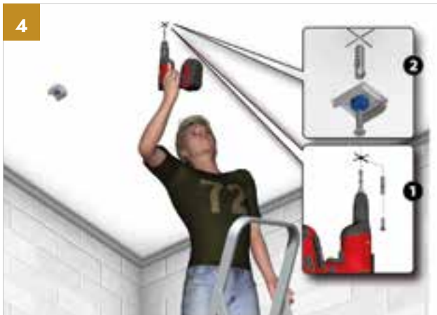
Fixation des crochets d'espacement à trou passant de type SILENS.
