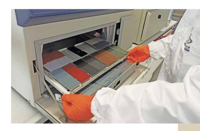
L'essai se termine par une comparaison entre le spécimen soumis au vieillissement et une matrice stockée en laboratoire, à l'abri de toute source de lumière. Cela permet d'évaluer la dégradation à la fois avec une méthode visuelle et instrumentale en analysant le changement de couleur subi par l'échantillon soumis au cycle de vieillissement.
