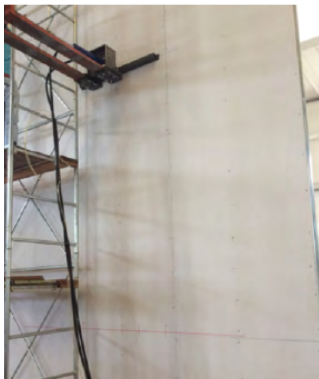
Essai de résistance aux charges horizontales sur les cloisons intérieures - poussée à mi-hauteur de la cloison
