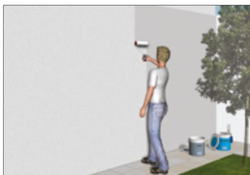
Appliquer le revêtement coloré avec une truelle en acier déposant une épaisseur uniforme. Avant que le produit commence à filmer, terminez par des mouvements circulaires à l'aide d'une spatule en plastique.
