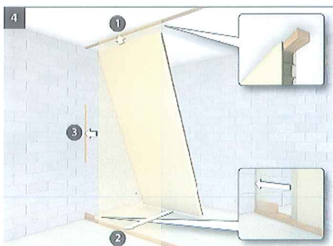
Figure 4 – Mise en œuvre du premier panneau (2/2)
